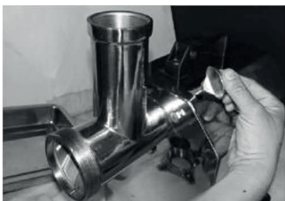
Fig. 5. Scoateți melcul; aveți grijă să nu pierdeți șaiba din nailon.
