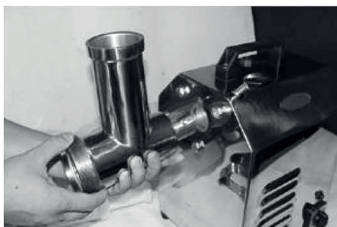
Fig. 6. Îndepărtați întregul gât de alimentare, susținând aparatul în timpul deșurubării piulițelor de fixare.
