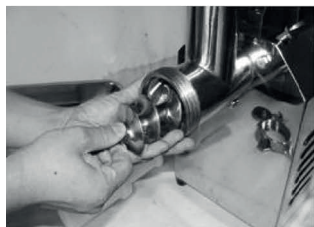
Fig. 4. Îndepărtați cu grijă cuțitul de tăiere, având grijă la muchiile ascuțite.
